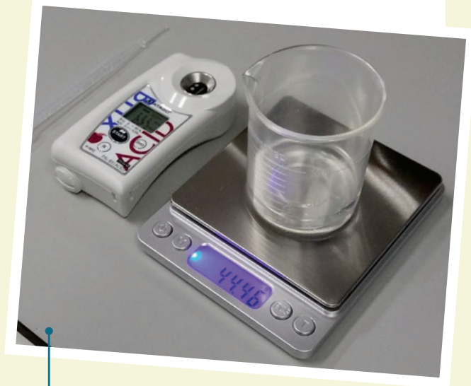
Foto 1 De Pocket Brix-Acidity meter (PAL-BX|ACID5) specifiek voor zuurmetingen bij appel.
