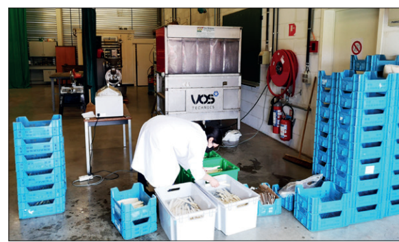
Figuur 1. Hittebehandeling van de asperges in warmwaterbad gevolgd door hydrokoeling
