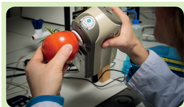
Figuur 3: Spectrofotometer om de kleur van de vruchten te meten.
