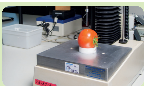
Figuur 2: Textuurmeter om de stevigheid van de vruchten te bepalen.
