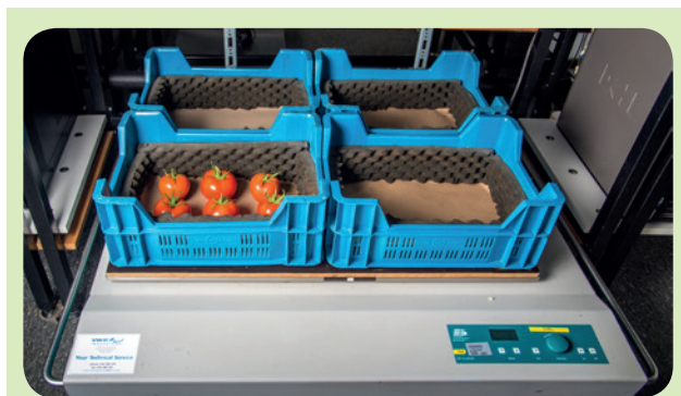
Figuur 1: Schudtafel om de prikschadegevoeligheid van vruchten te testen.
