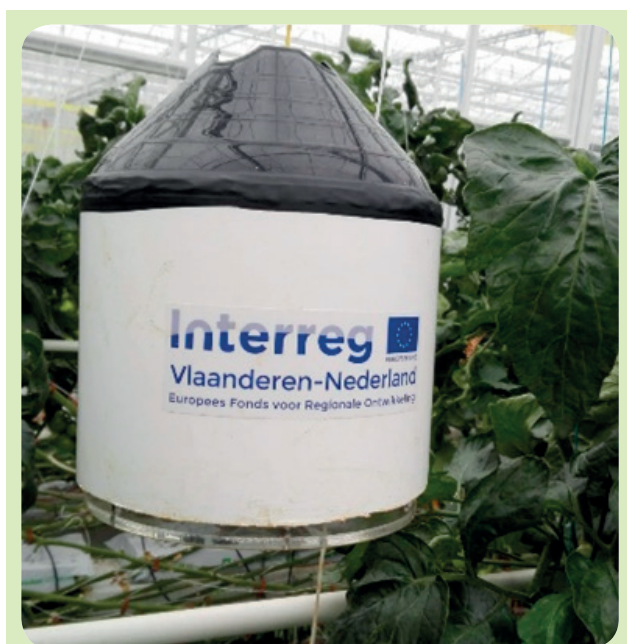
Figuur 1: Draadloze temperatuur- en luchtvochtigheidsensoren in een bescherming met passieve koeling.
