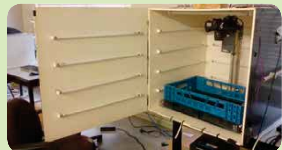
Figuur 5: Met deze lichtbox met camera zou je in de toekomst de kleur van een volledige kist prei kunnen meten.
